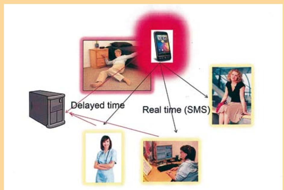
Abb. 3: Sturzdetektion in der Häuslichkeit mittels am Körper getragener Bewegungssensoren. Bei einem Sturzereignis werden über Smartphone-Anwendungen in Echtzeit Rettungsdienste und Angehörige informiert. Die aufgezeichneten Sturzdaten werden im Anschluss (delayed time) in die Sturzdatenbank eingespeist.
